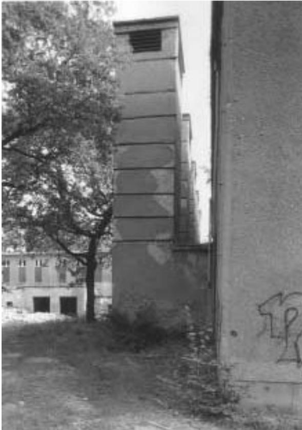
Abb.6: Netzersatzgebäude, Auspuff für Dieselaggregate,
