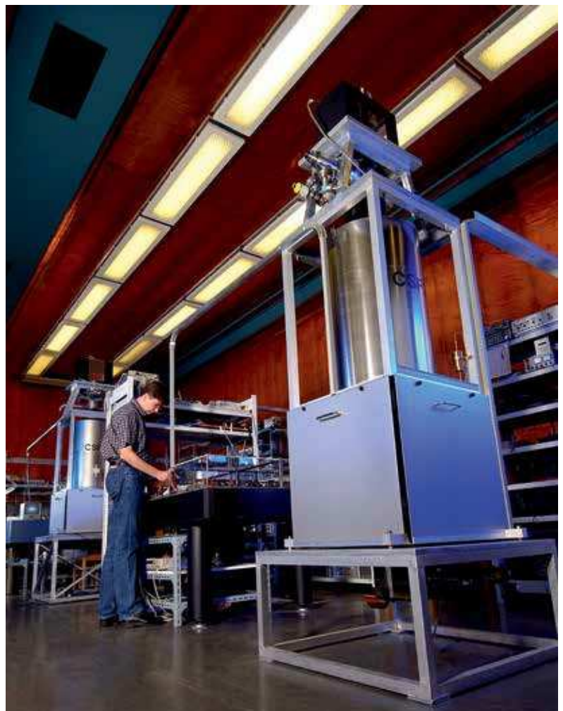
Bild 5: Die PTB-Caesium-Fontänenuhren CSF1 (im Hintergrund) und CSF2 (im Vordergrund) im Jahr 2005
