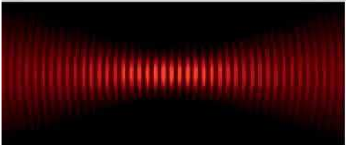
Bild 7: Die einfachste Atomfalle für eine optische Gitteruhr entsteht durch einen in sich zurück reflektierten Laserstrahl. Hier ist schematisch die Intensitätsverteilung einer solchen Stehwelle zu sehen: In Strahlrichtung sind die Intensitätsmaxima, die die Atome speichern, 400 nm breit, lateral dazu 150 \mu\text{m} .
