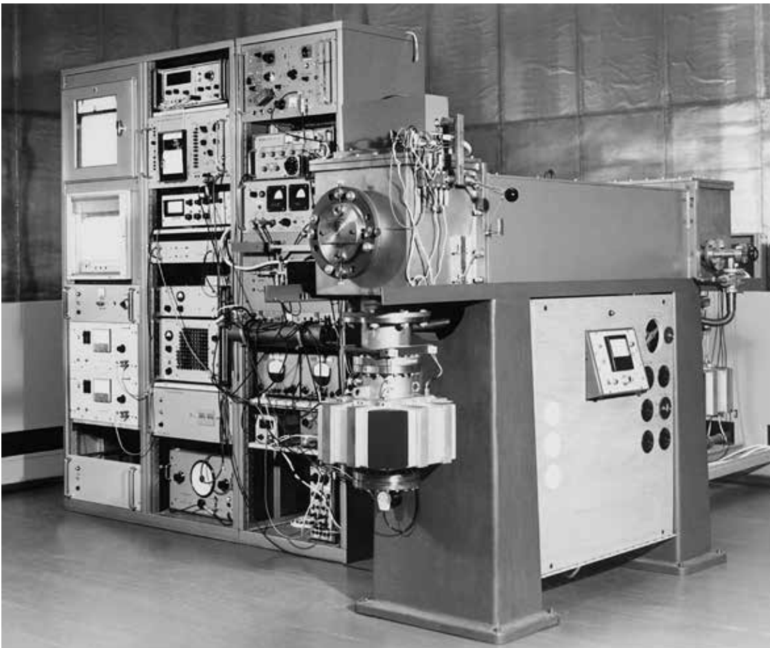
Bild 2: Die primäre Atomstrahluhr CS1 in der Atomuhrenhalle der PTB (1969)
